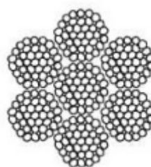
Канат типа ТК с металлическим сердечником ГОСТ 3068-88
